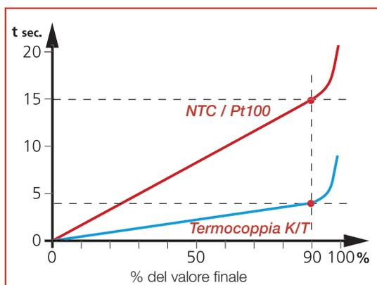
Tempo di risposta per sonda immersa in un liquido
