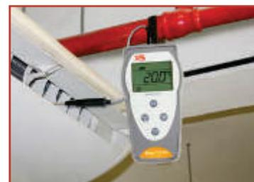
Misura della temperatura in sistemi di condizionamento
