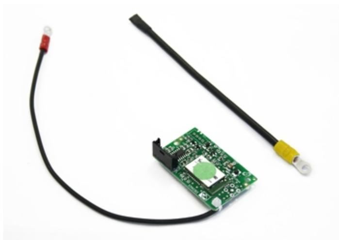
Interfaccia che permette la conversione di un segnale RS232 in radiofrequenza 868MHz. Fino a 50 canali di trasmissione, configurabili tramite programma per PC. Grazie ai consumi ridotti e alla grande distanza di trasmissione, è ideale per la realizzazione di sistemi mobili di pesatura o trasmissioni radio wireless.
